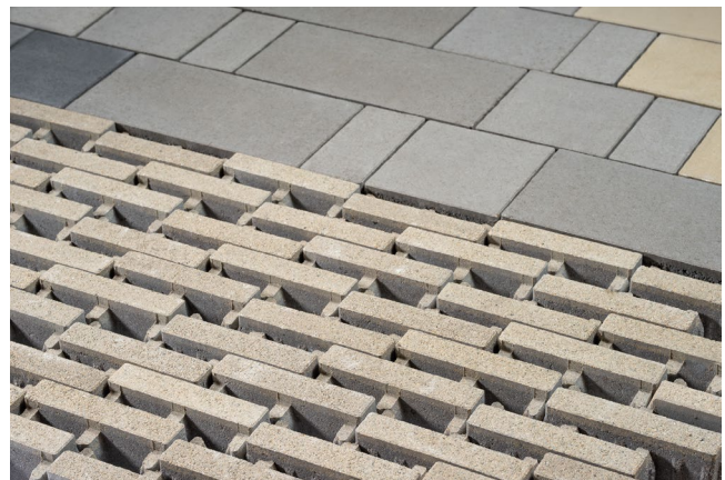
Voorbeeld van Strike in om-en-om-verband. Plaats de stenen éénmaal met de rugkant en éénmaal met de nokken tegen de kantopsluiting en pas daarbij een halfsteensverband toe.
