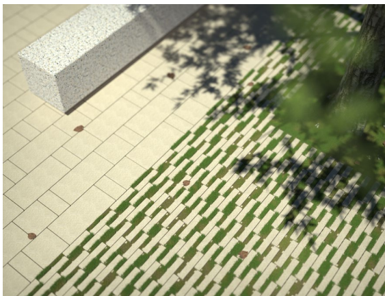
Voorbeeld van Strike in om-en-om-verband. Plaats de stenen éénmaal met de rugkant en éénmaal met de nokken tegen de kantopsluiting en pas daarbij een halfsteensverband toe.
